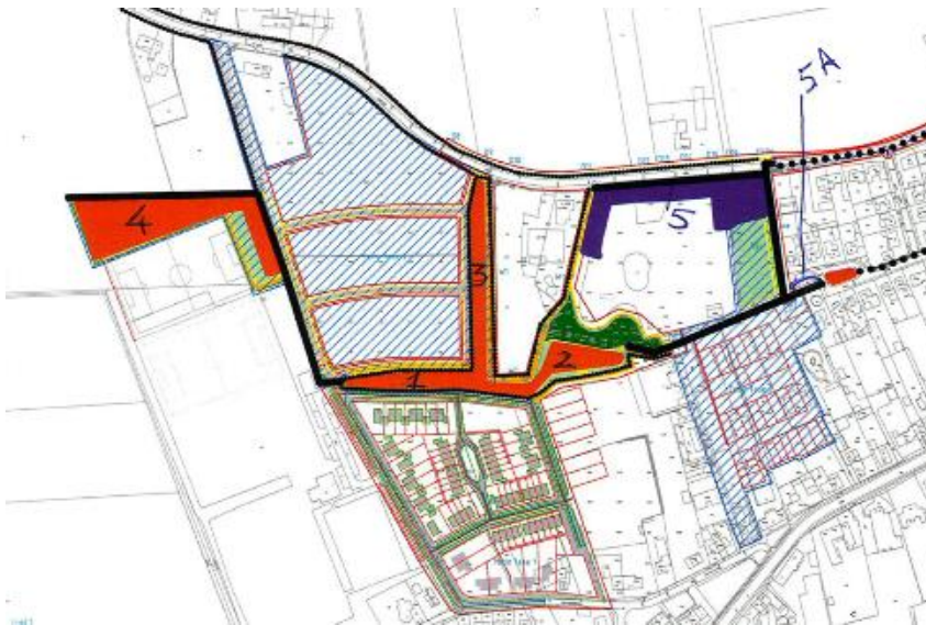
Figuur 2: Retentievoorzieningen binnen het gehele plan Terlo.
